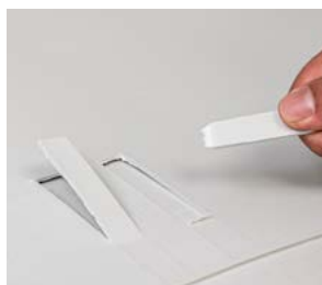
Test odrywania (2 cm z odrywaniem poza połączeniem)
