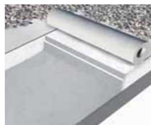
Ułożenie luźne na dachu balastowym
