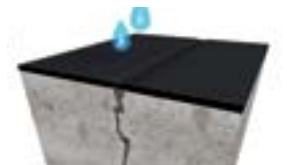
Uszczelnienie mostkujące rysy: w takim przypadku poprzez samą grubość powłoki i elastyczność materiału uszczelnienie jest w stanie skutecznie przeciwdziałać naporowi wody pod ciśnieniem
