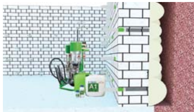
Iniekcja kurtynowa za ścianą murowaną
