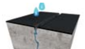
Uszczelnienie elastyczne, ale nie mostkujące rysy może nie sprostać ciąglemu oddziaływaniu wody pod ciśnieniem
