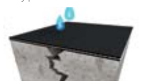
Powłoka mostkująca rysy z włókniną wzmacniającą: włóknina oddziela od powstałej rysy górną warstwę powłoki znajdującą się nad nią i ma decydujące znaczenie dla utrzymania szczelności dla wody napierającej pod ciśnieniem.
